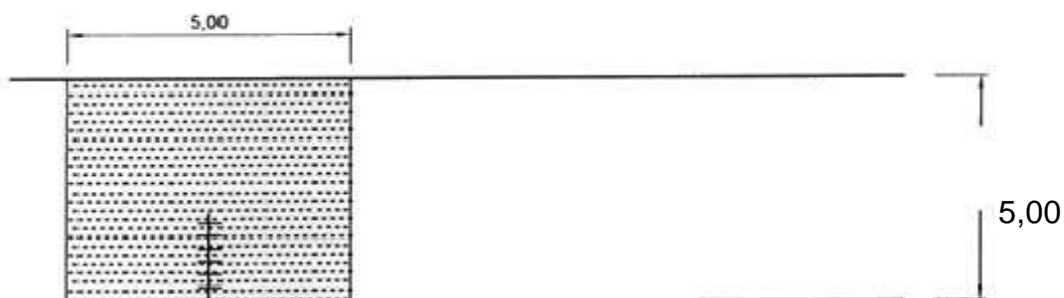
figura 2 scavo trasversale alla carreggiata
