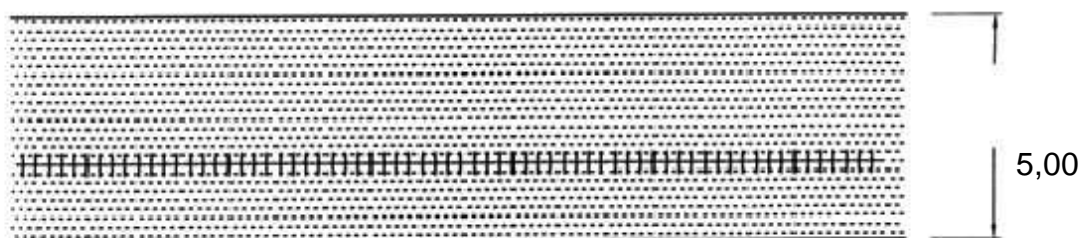
figura 1 scavo longitudinale alla carreggiata
